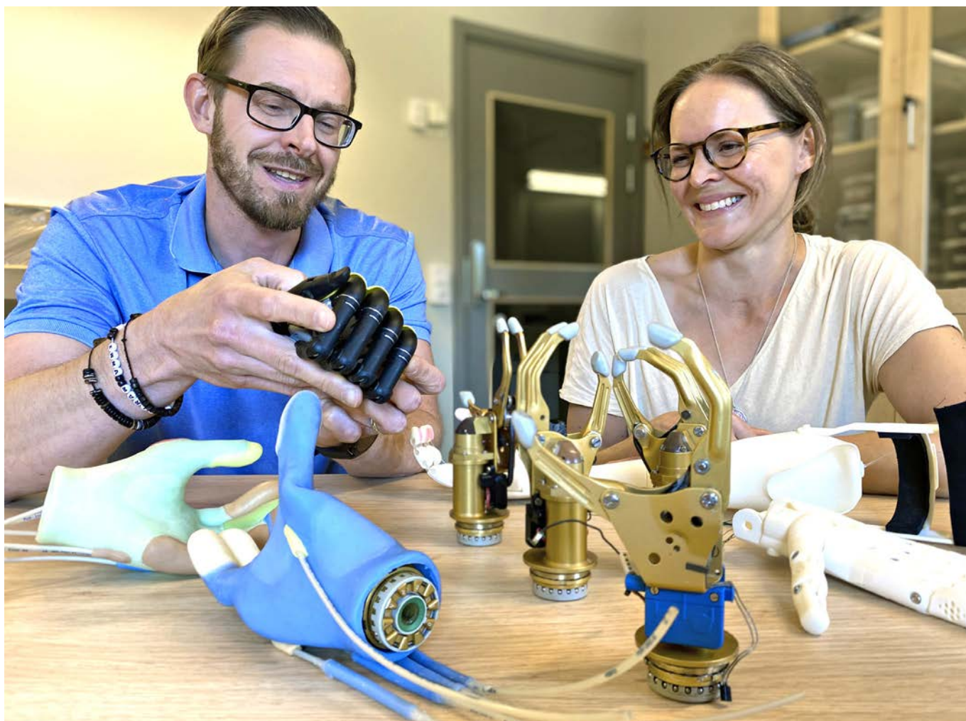
Christian Antfolk och Ulrika Wijk med ett flertal olika tankestyrda – eller myoelektriska – proteser.
